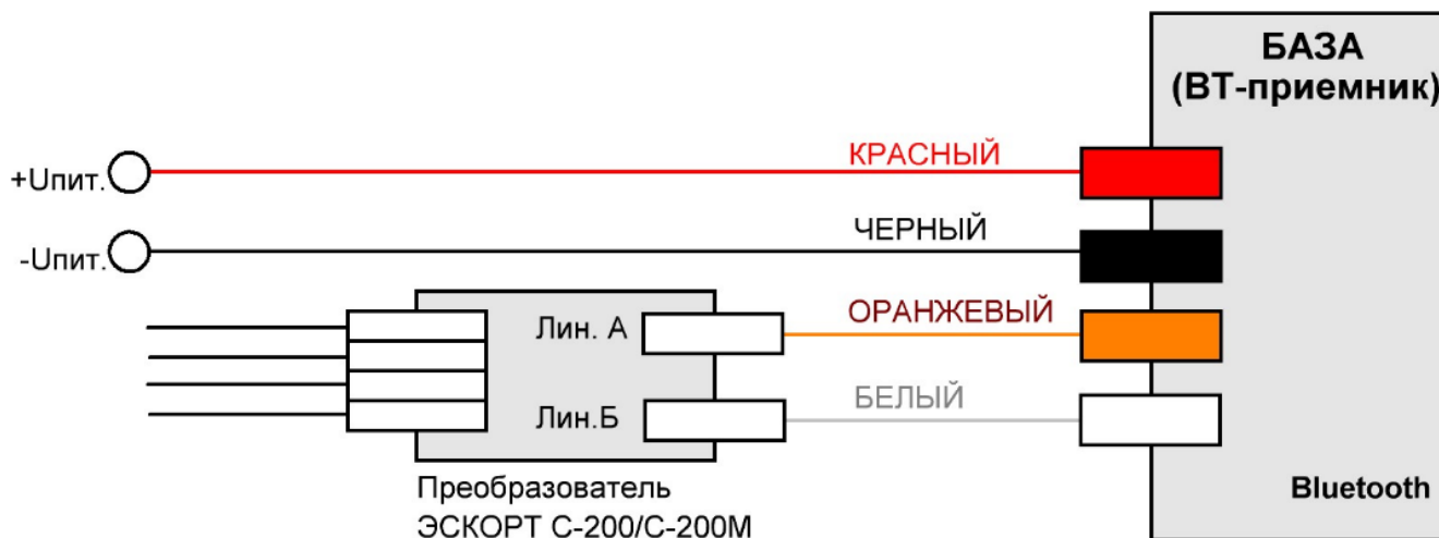
Схема подключения базы BLE-BASE в режиме программирования
